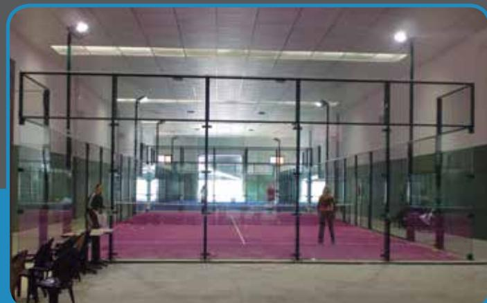
La estructura principal de la pista es metálica, a base de acero laminado en caliente de calidad S-275-JR y S-235-JR, mediante perfiles de 100x60x2 y 60x60x2
