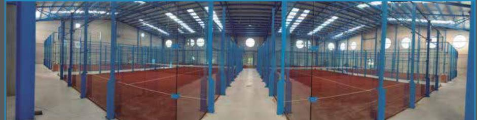
La structure principale du court est métallique, à base d'acier laminé en chaud de qualité S-275-JR et S-235-JR, moyennent un profil de 100x60x3 mm et 80x60x2.
